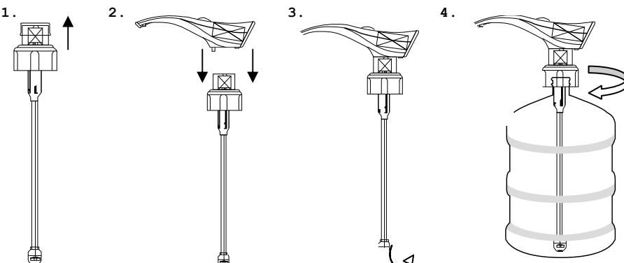
1. Снять защитную чашу с тела помпы, как изображено на рис.1.
